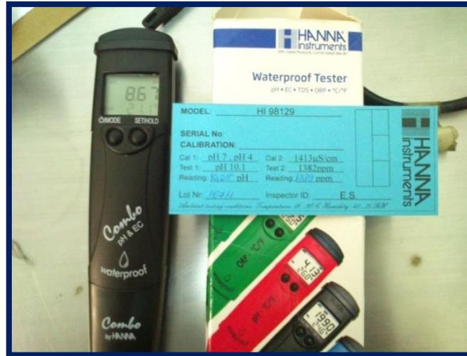
Figura 5.19. Equipo utilizado para la medición de pH.
