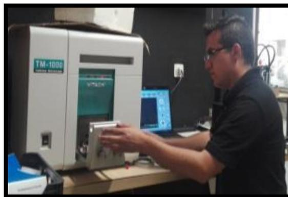
**Figura 5.60. Encendido del microscopio electrónico de barrido.**
