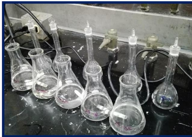
**Figura 5.40. Preparación de las soluciones para la curva de calibración**
