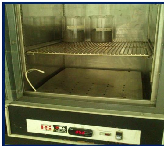
Figura 5.20. Secado de muestras a 35°C en un horno de convección.
