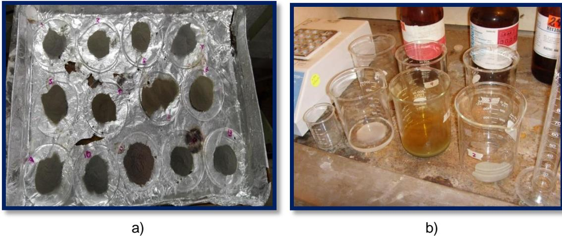
**Figura 5.31. Pesado, colocación de la muestra en vasos de precipitados y adición de ácido nítrico. Donde: a) colocación de la muestra en vidrios de reloj y b) adición de ácido nítrico en las muestras.**
