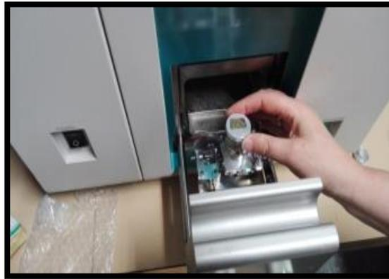
**Figura 5.59. Colocación del porta muestras en el microscopio electrónico de barrido.**
