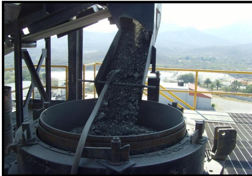
**Figura 3.3. Trituración del material proveniente de la mina.**
