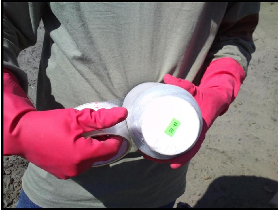
**Figura 5.8. Sellado de recipientes con cinta adhesiva, que contienen a las muestras para evitar el contacto con el oxígeno hasta el análisis en laboratorio.**
