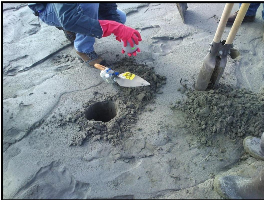
Figura 5.7. Toma de la muestra JLP1, en la presa número 4 a una profundidad de 30 cm.
