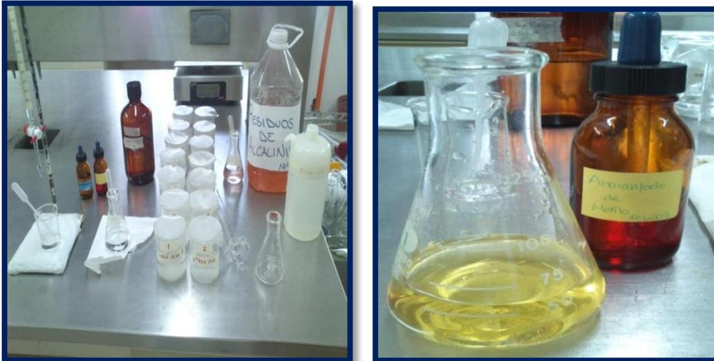
Figura 5.54. Determinación de Alcalinidad en lixiviados de prueba cinética.
