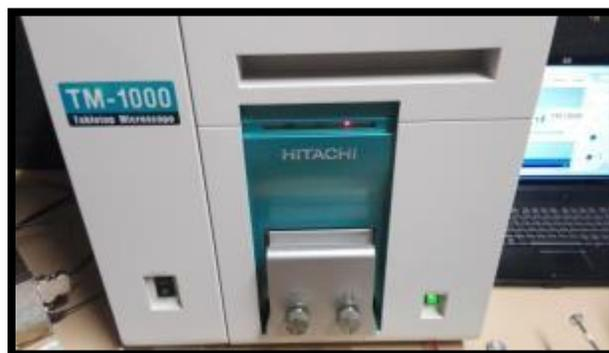
Figura 5.55. Microscopio electrónico de barrido Hitachi TM-1000
