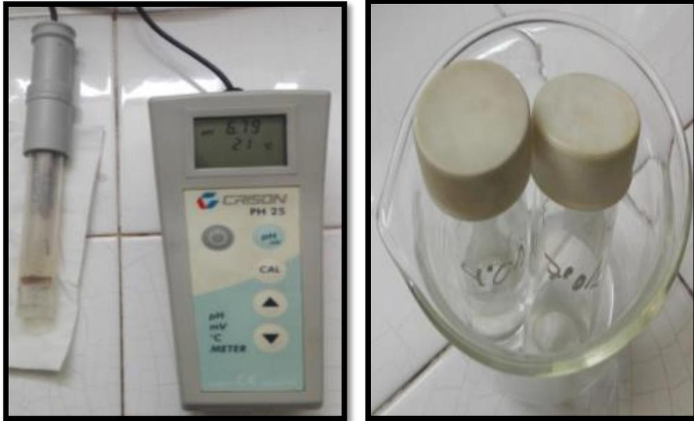
**Figura 5.14. Calibración del medidor de pH.**
