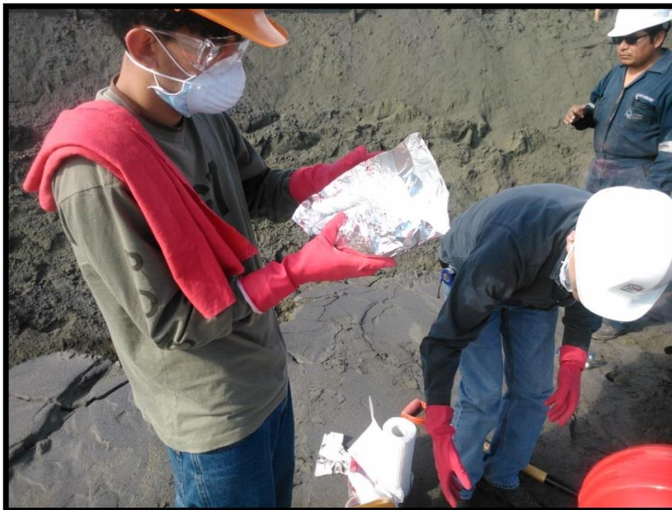
**Figura 5.9. Cubriendo con papel aluminio los recipientes que contienen a las muestras para evitar el contacto con la luz hasta su refrigeración.**
