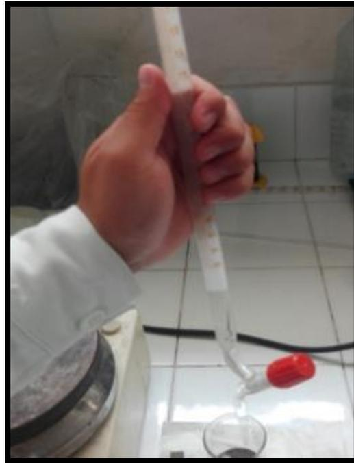
**Figura 5.16. Adición de la cantidad de agua destilada y desionizada a la muestra.**
