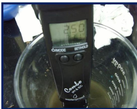
**Figura 5.28. Medición de pH después de la agitación y adición de HCl hasta la disminución de la acidez a un pH de 2.5.**
