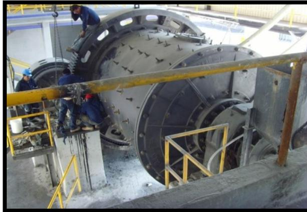
Figura 3.4. Molienda por medio de un molino de bolas.
