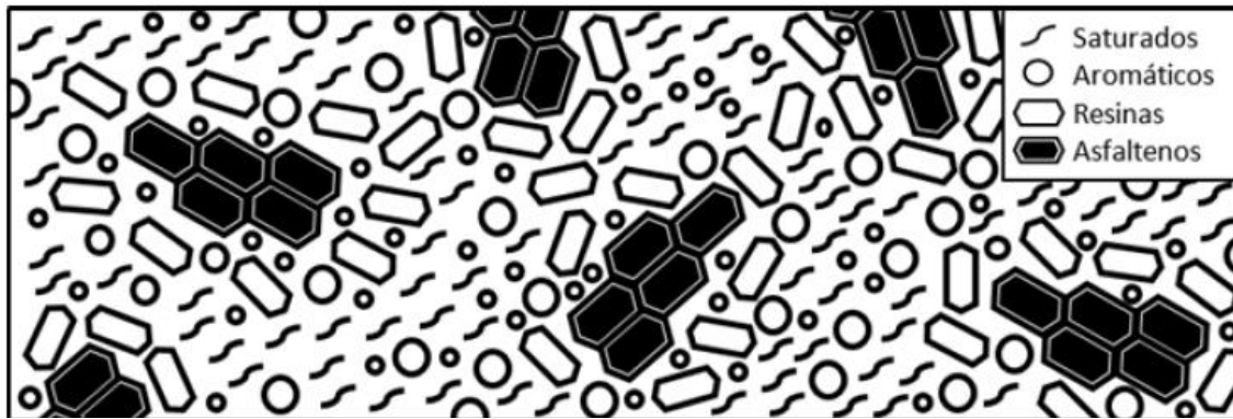
Figura 2.6 Diagrama coloidal de agregación de un material asfáltico.[11]
