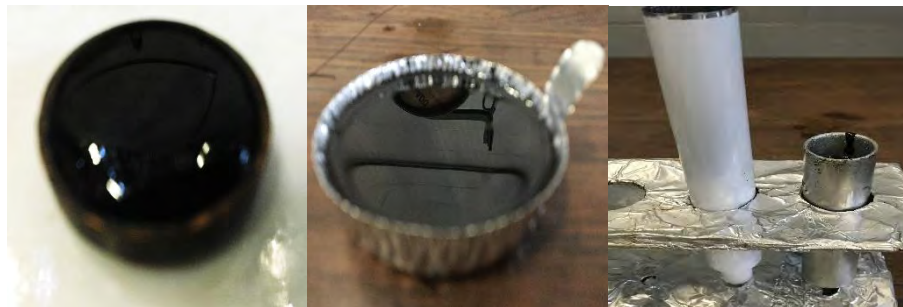
Figura 4.3 Anillo, charola, tubo metálico y portamuestra Brookfield, conteniendo asfalto.
