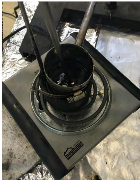
Figura 4.4 Modificación de asfalto a 180 °C y 200 RPM.
