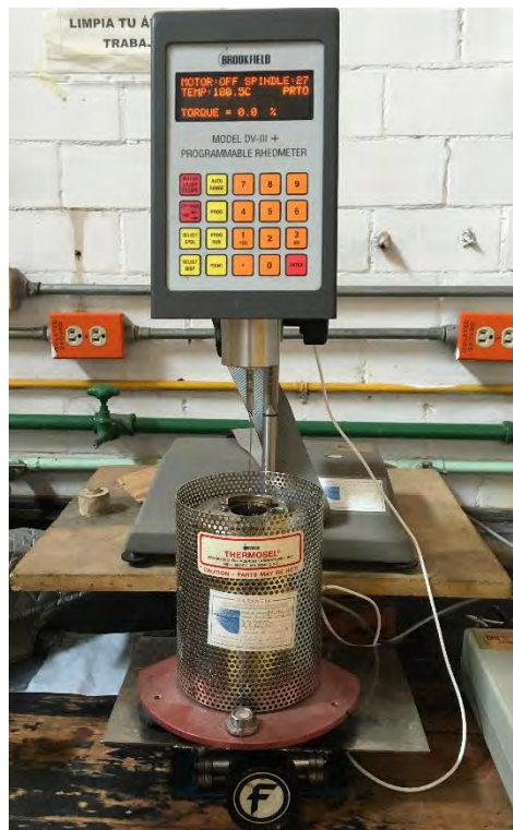
Figura 4.9 Brookfield y termocelda. Componentes del equipo de viscosidad.
