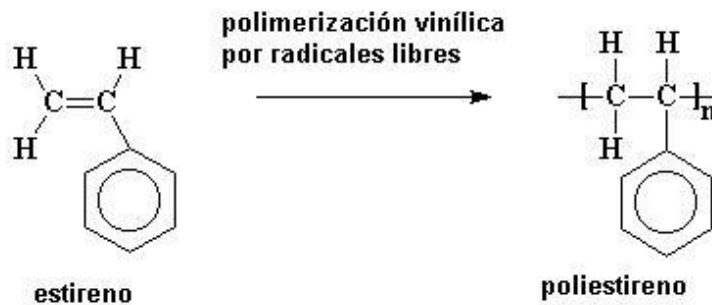
Figura 2.10 Formación del polímero poliestireno. A la izquierda, el estireno (monómero), a la derecha, el poliestireno (polímero).[15]
