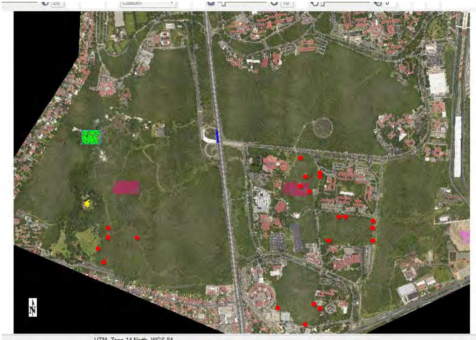
Figura 27. Puntos de verificación en campo (color rojo) utilizados para calibrar el software. Imagen de la Ciudad Universitaria de la UNAM tomada por el dron (Peralta, 2015).
