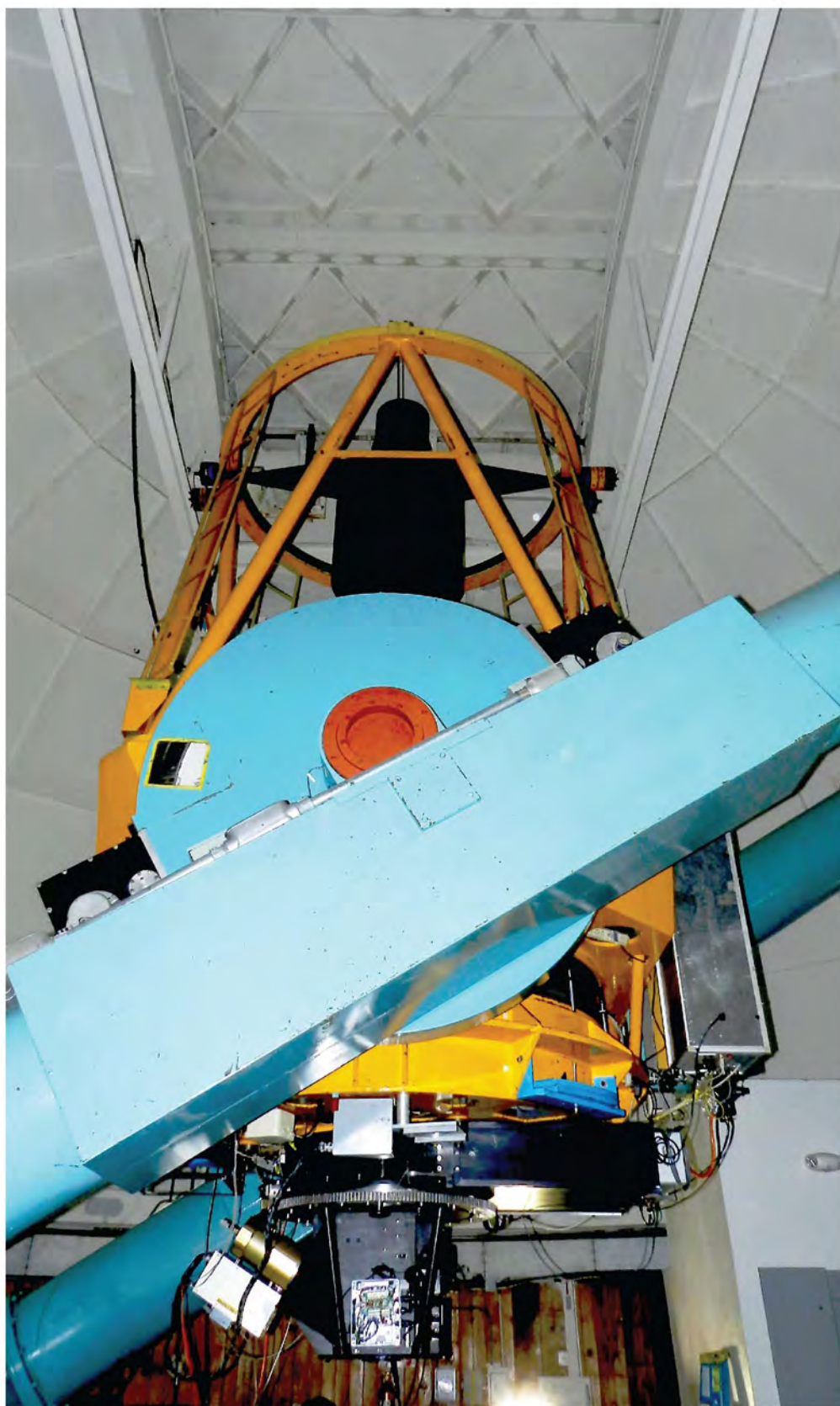
Figura 8.9: El sistema de control instalado en el instrumento PUMA que a su vez está montado en el telescopio de 2.1m. Fotografía tomada por Zimri Marsilli.
