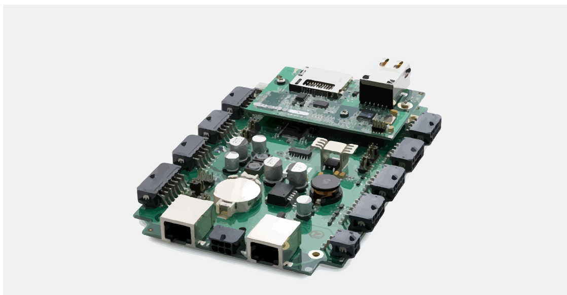
Figura 4.1: Controlador del nuevo sistema electrónico, el microcontrolador de mono-placa reducida Rabbit BL4S200. Referencia (Digi-Semiconductor, 2013a).
