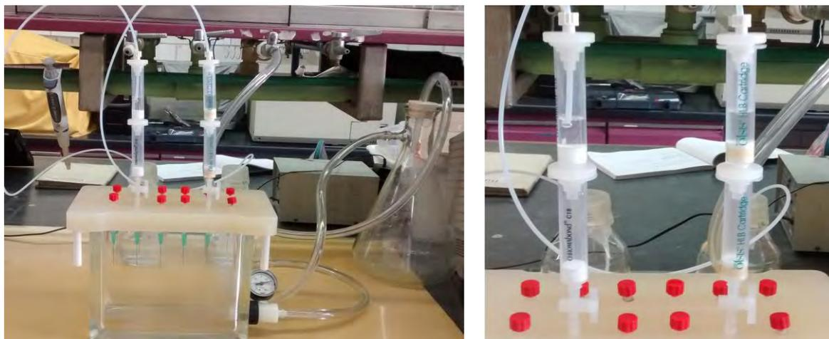
**Figura 9.** Montaje del sistema de extracción para determinar el volumen de fuga
