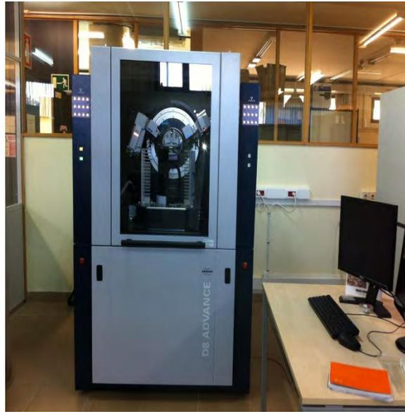
**Figura 3. 3.** *Difractómetro de rayos x: Bruker D-8 Avanzado AXS*
