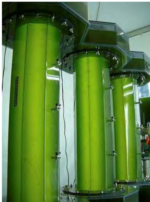
Imagen 2. Fotobioreactores de la empresa Biofuels systems
