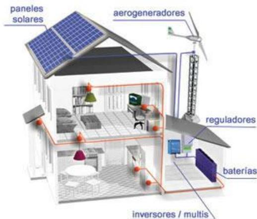
Figura 43. Esquema de funcionamiento de un sistema híbrido (solar v eólica)
