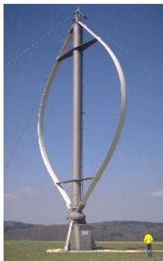
Figura 38. Aerogenerador Darreius
