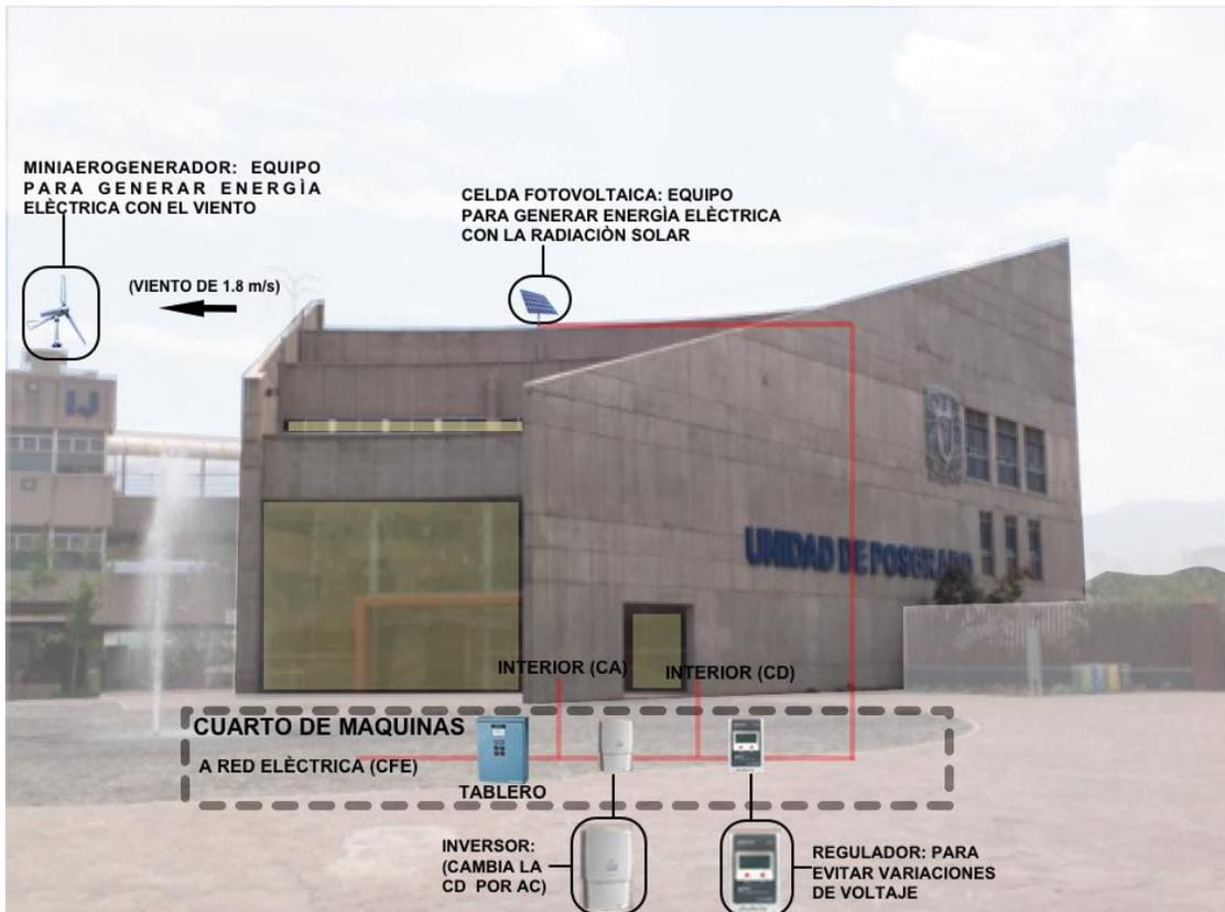
Figura 91. Esquema de funcionamiento del modelo operativo
