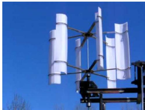
Figura 39. Aerogenerador Savonius
