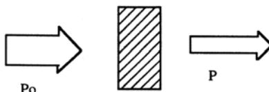
**Figura 3.5. Fenómeno de absorción de energía electromagnética.**
