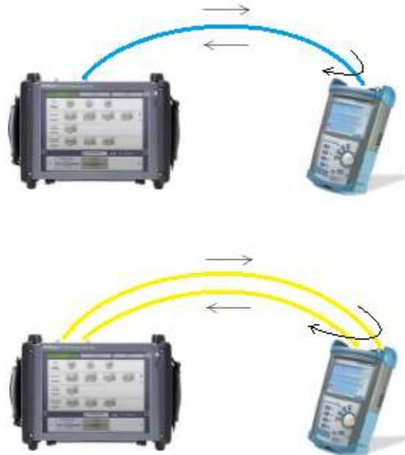
Figura 4.1 - Esquema de conexiones para las pruebas iniciales para servicios Ethernet con cable UTP (arriba) y con fibra (abajo).
