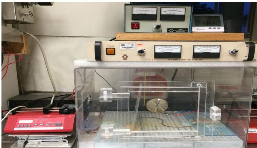
Figura 1.8 Fotografía del equipo de electrohilado utilizado, en el que se observan los componentes del equipo con fuente de poder (FEM), sistema de inyección, y colector.
