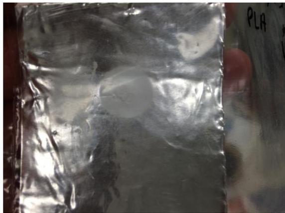
Figura 3.4. Fotografía de la membrana al 15% de PLA/TFE donde se observa que no se obtuvieron buenos resultados, respecto a las otras composiciones en las cuales si se observan membranas bien definidas.
