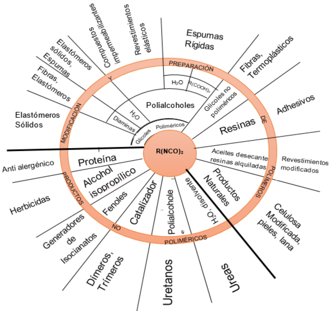
Figura 3. Diferentes materiales creados con los isocianatos y los nucleófilos utilizados para los mismos [21].
