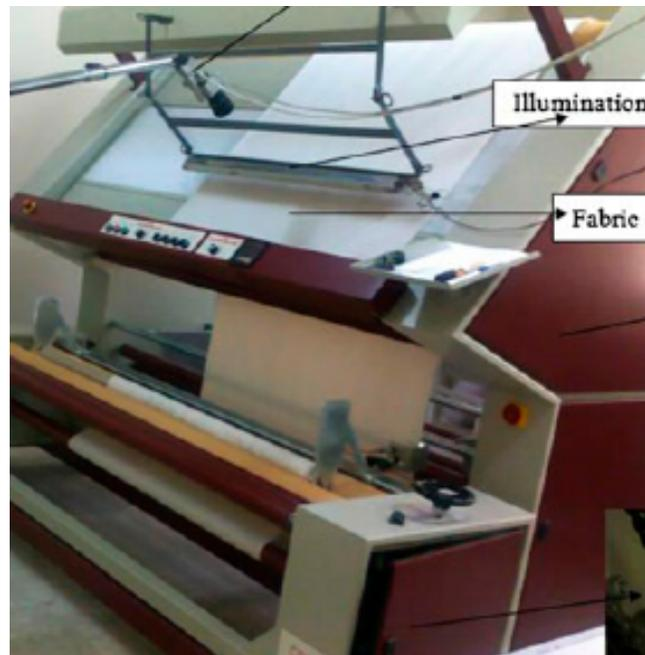
Figura 4.5: Sistema de visión computacional para detectar defectos en telas
