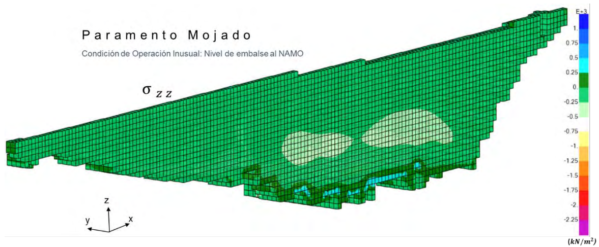
Figura 6.18. Esfuerzos verticales máximos de la cortina (Condición 2).
