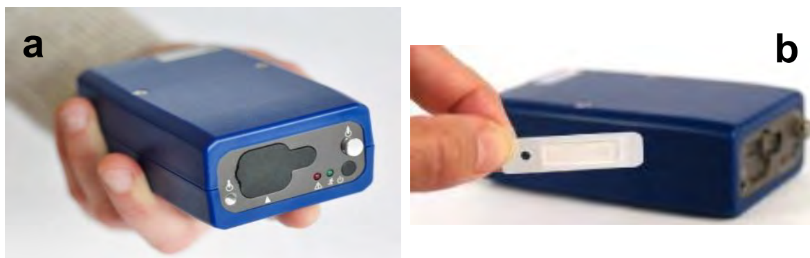
Figura 2. a) Imagen del micro-etatómetro (modelo AE-51), instrumento portátil que mide la absorción de las partículas. A diferencia de los otros modelos, el AE-51 no emplea una cinta para depositar las partículas, sino que, como se observa en b), éstas se analizan sobre filtros que deben cambiarse manualmente cuando se saturan (AethLabs, 2014).
