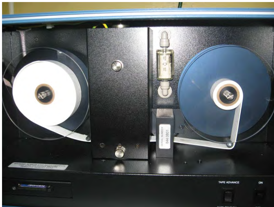
Figura 1. Vista de la parte interna de un etalómetro convencional: en la imagen se ve la cinta, hecha de fibra de cuarzo, sobre la que se depositan las partículas atmosféricas.
