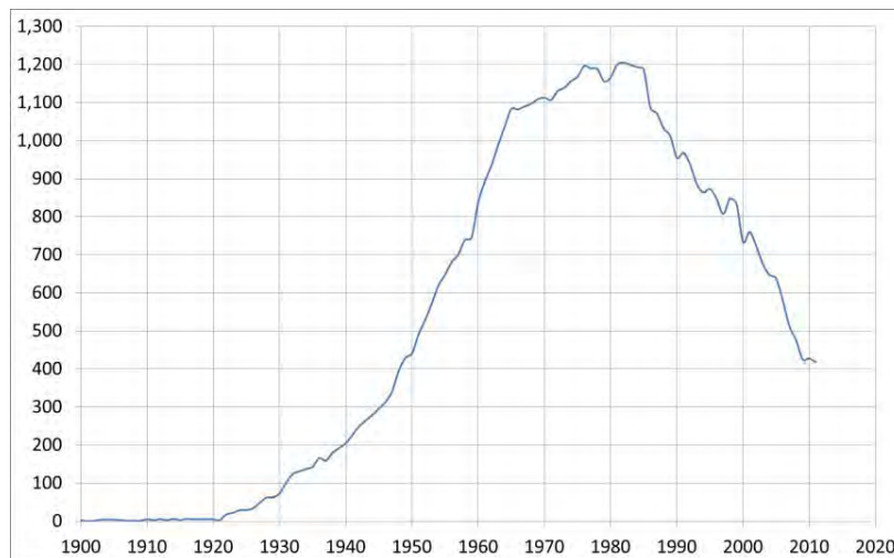
Figura 2.1 Número de estaciones hidrométricas activas en la República Mexicana desde 1900 hasta 2012 Fuente: CONAGUA
