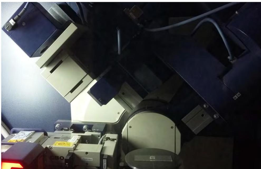
**Figura 2.14. Difractómetro de Rayos-X marca Rigaku empleado para obtención de datos de macrotextura, esfuerzos residuales y microdeformaciones en muestras procesadas por ECAP.**
