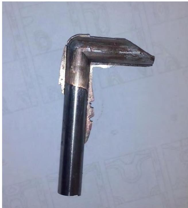
**Figura 2.7.** Muestra demostrativa de la deformación sufrida al pasar por el canal angular y la formación de “camisa” debido al flujo de material dentro de las intersecciones de las dos partes que conforman el cono interno.
