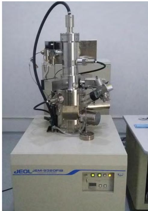
**Figura 2.8. Micromaquinado con haz de iones focalizado marca Jeol empleado para preparación de laminillas para TEM y toma de micrografías con ataque de haz de iones de galio.**
