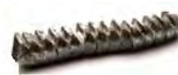
Figura 2.4. Probeta con extrusión fallida sin tratamiento térmico previo.
