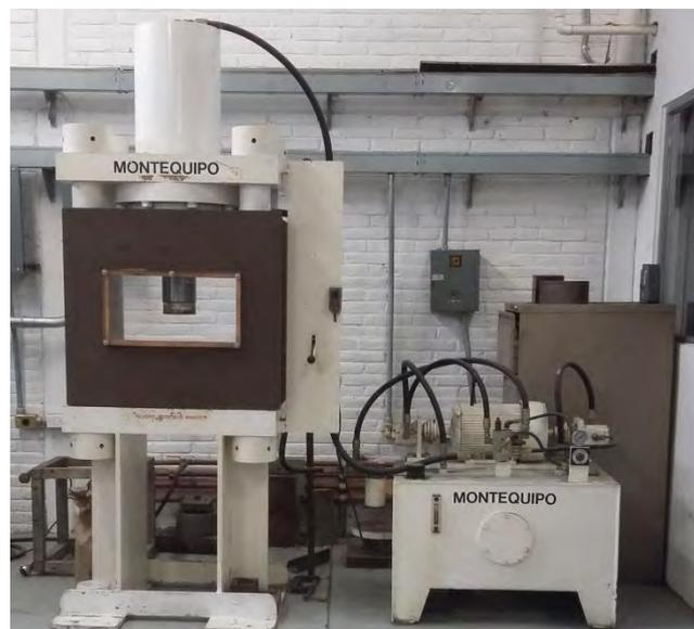
**Figura 2.5. Prensa hidráulica empleada para proceso ECAP.**
