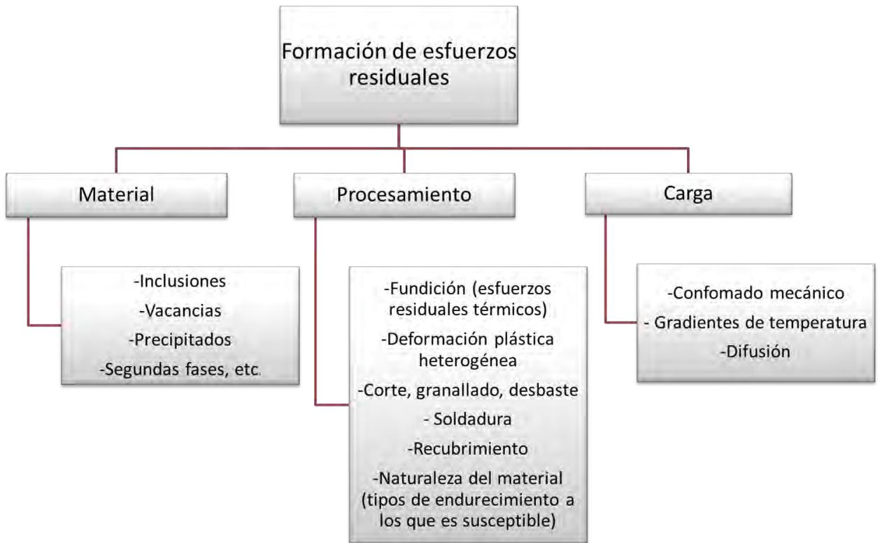
Figura 1.5. Causas de la generación de esfuerzos residuales, adaptada de [36].
