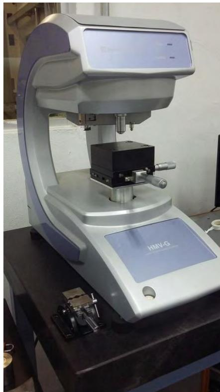
**Figura 2.16. Microdurómetro Vickers marca Shimadzu empleado para la medición de perfil de dureza.**
