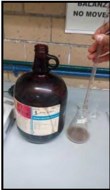
Figura 27. Adición de solución ácida a la calcina.
