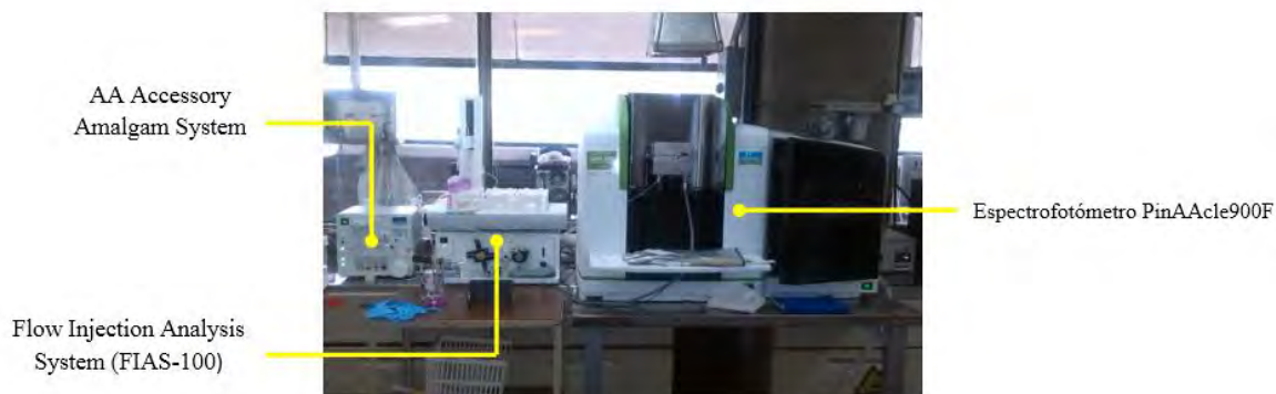
FIGURA 1. Ejemplo de la instalación de equipos pinAAcle900F, FIAS-100 con sistema de amalgamación.
