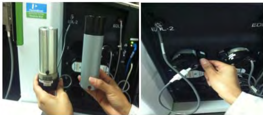
FIGURA 5.1 Ejemplo de colocación de lámparas.
