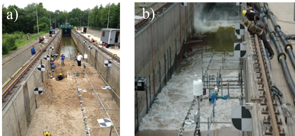
Figura 5: a) Vista posterior del experimento BARDEX, mostrando el perfil de playa y la instalación de instrumentación. b) Estructura utilizada para el arreglo de sensores bajo la acción del oleaje.
