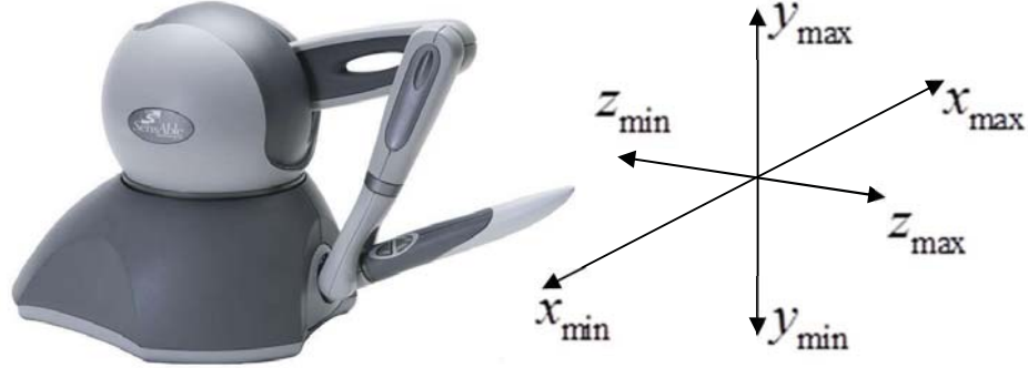
Figura 80. Sistema de coordenadas y volumen de trabajo del dispositivo háptico PHANTOM OMNI.
