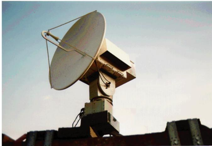
Radar de banda X del LTHE de Grenoble instalado junto a Marsella durante la experiencia HIRE.
