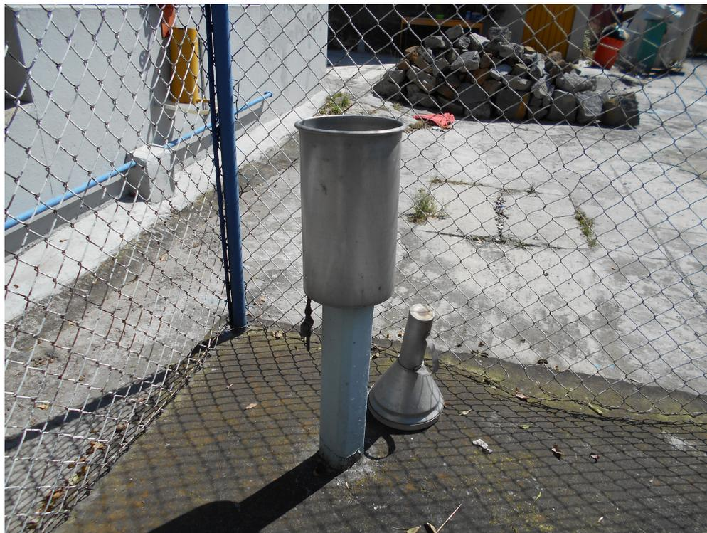
Figura 1.8: Pluviómetro.
