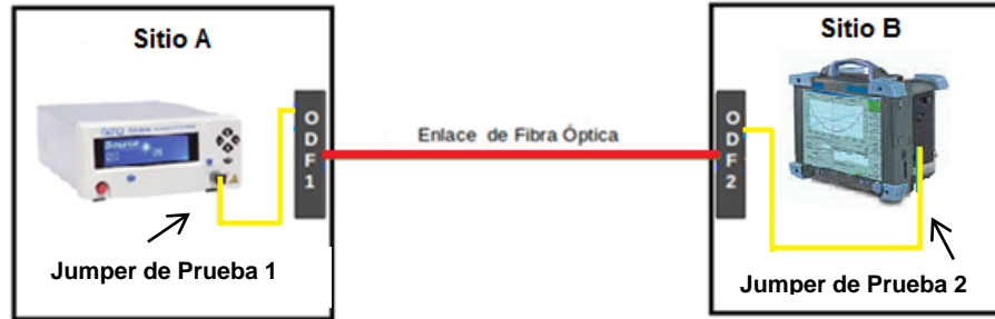
Figura 2.3. Diagrama de conexiones utilizado para realizar mediciones de Dispersión Cromática en el enlace 1.
