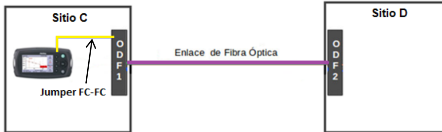
Figura 2.45. Diagrama de conexiones utilizado para realizar mediciones con OTDR en el enlace 3.
