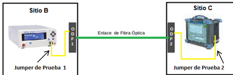
Figura 2.25. Diagrama de conexiones utilizado para realizar mediciones de Dispersión Cromática en el enlace 2.
