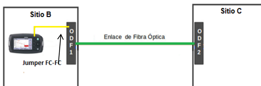
Figura 2.24. Diagrama de conexiones utilizado para realizar mediciones con OTDR en el enlace 2.
