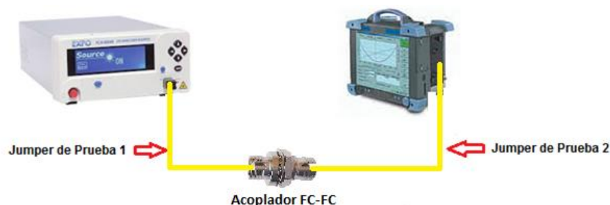
Figura 2.2. Establecimiento de referencia para medir Dispersión Cromática.
