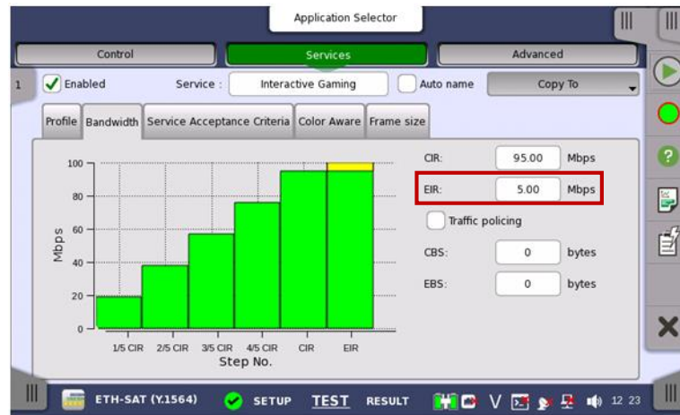
Figura 5.9. Configuración de EIR para el servicio de Gaming Interactivo.
