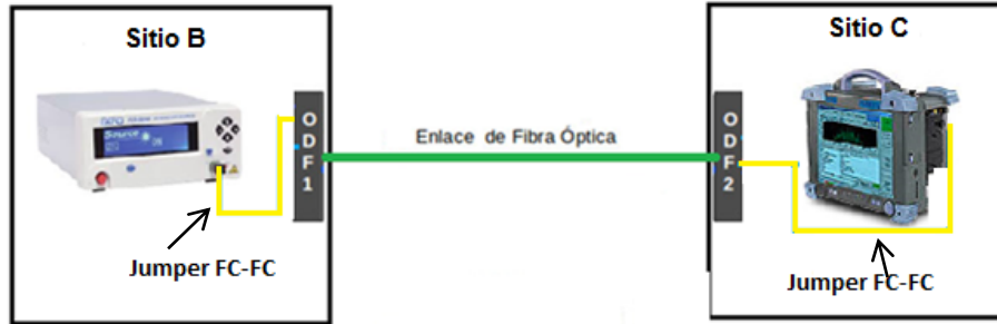
Figura 2.26. Diagrama de conexiones utilizado para realizar mediciones de Dispersión por Modos de Polarización en el enlace 2.
