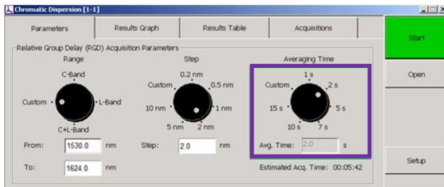
Figura 2.56. Configuración del tiempo promedio del Analizador de Dispersión Cromática para el enlace 3.
