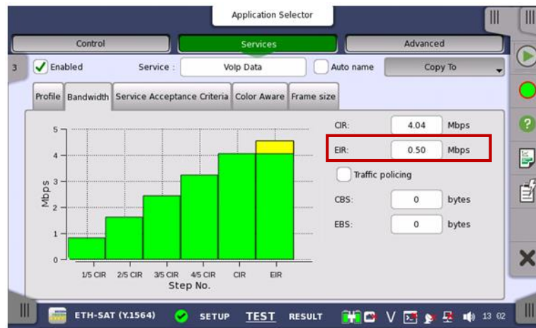
Figura 5.16. Configuración de EIR para el servicio de VoIP.
