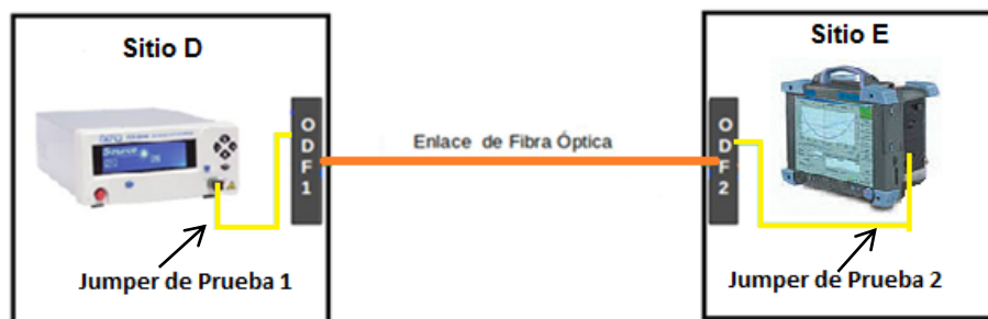
Figura 2.67. Diagrama de conexiones utilizado para realizar mediciones de Dispersión Cromática en el enlace 4.
