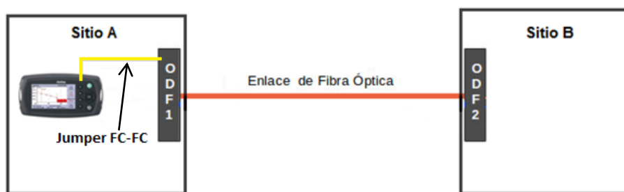
Figura 2.1. Diagrama de conexiones utilizado para realizar mediciones con OTDR en el enlace 1.
