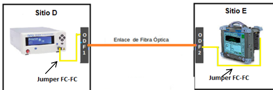
Figura 2.68. Diagrama de conexiones utilizado para realizar mediciones de Dispersión por Modos de Polarización en el enlace 4.
