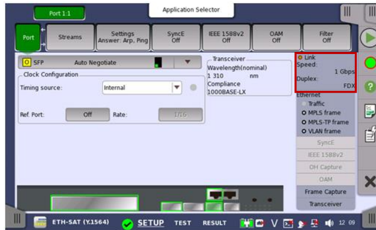
Figura 5.3. Verificación de Link y velocidad de transmisión del Equipo Local (Maestro).
