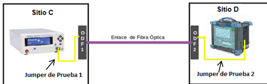
Figura 2.46. Diagrama de conexiones utilizado para realizar mediciones de Dispersión Cromática en el enlace 3.
