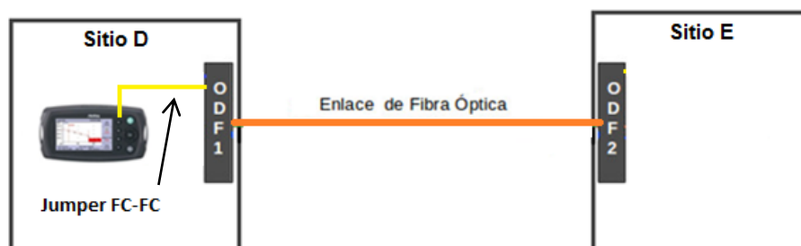
Figura 2.66. Diagrama de conexiones utilizado para realizar mediciones con OTDR en el enlace 4.
