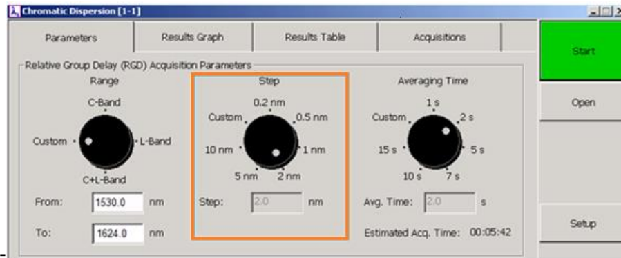
Figura 2.76. Configuración del incremento de longitud de onda del Analizador de Dispersión Cromática para el enlace 4.
