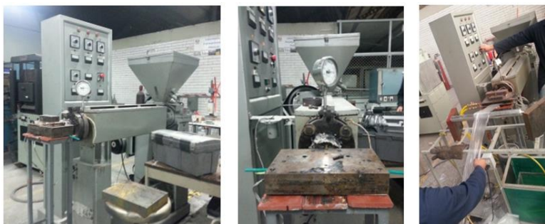
Figura 4. 7. Máquina de Extrusión del Laboratorio de Procesamiento de Plásticos de la Facultad de Ingeniería, UNAM, y proceso de obtención de las películas plásticas.
