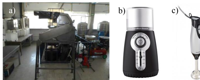
Figura 4. 4. (a) Trituradora industrial en el Laboratorio de Ingeniería Sanitaria, (b) molino marca “HAMILTON BEACH” y (c) licuadora de mano marca “HAMILTON BEACH”.
