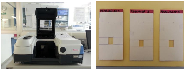
Figura 5. 2. Espectrofotómetro de Infrarrojo por Transformada de Fourier (FT-IR) marca “THERMO SCIENTIFIC” ubicado en el Laboratorio de Ingeniería Ambiental, en el Instituto de Ingeniería, UNAM.
