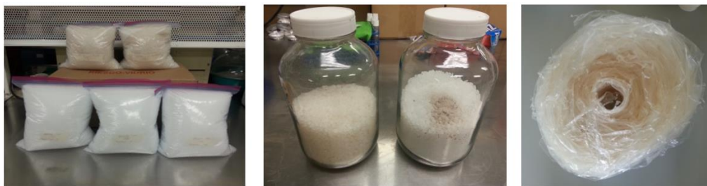
Figura 4. 6. Mezcla de los pellets de polietileno (PEBD) 20020 X de PEMEX con el estearato de manganeso, y película plástica obtenida.
