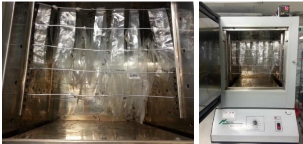
Figura 5. 1. Horno FELISA en el que se llevó a cabo el pretratamiento térmico de las películas plásticas de PEBD.
