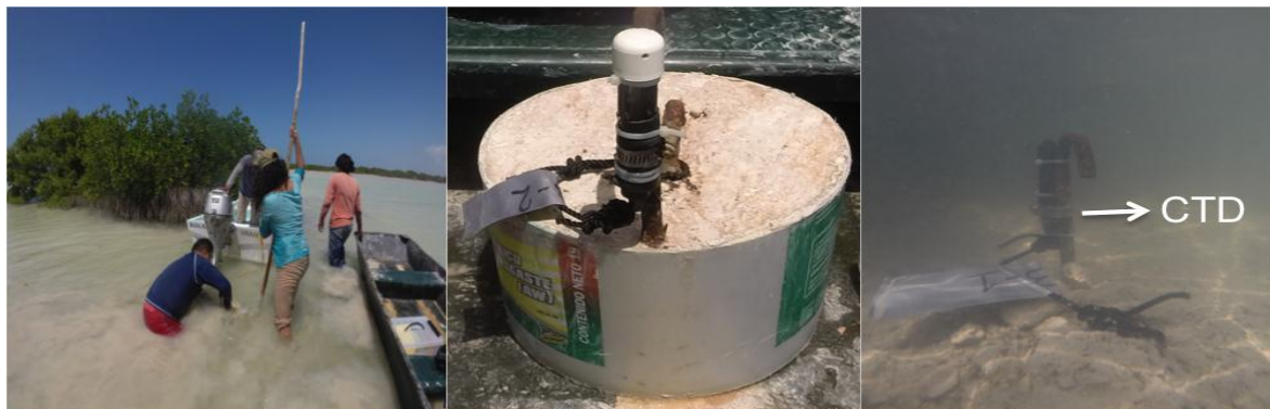
Figura 4. Colocación de CTD en anclajes de concreto enterrados en el fondo de la laguna.
