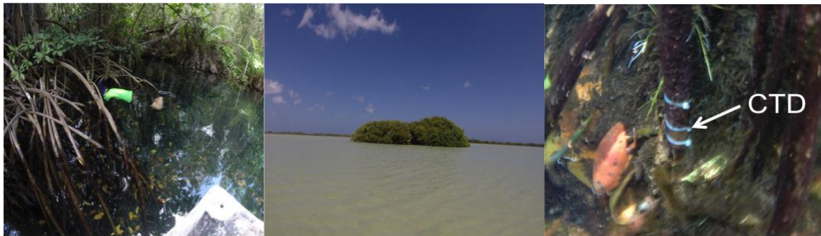
Figura 3. Instalación y fijación de CTD's en vegetación aledaña.
