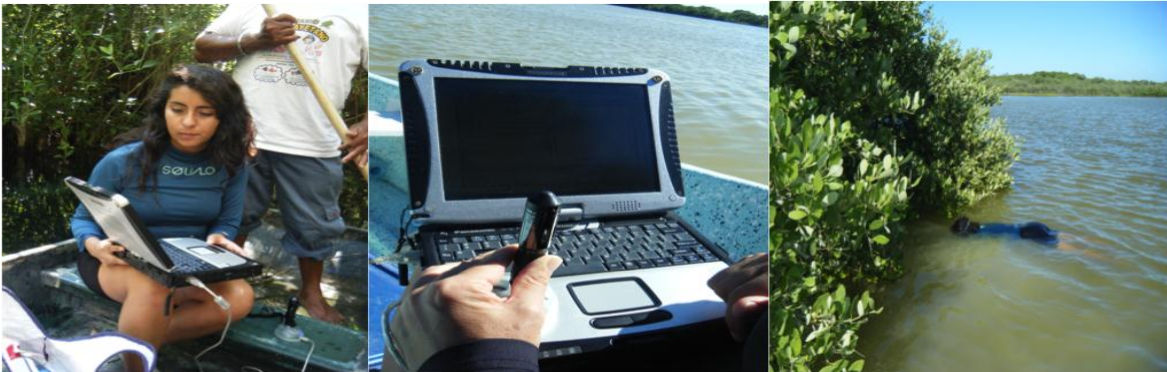
Figura 5. Descarga de los datos de CTD, configuración del nuevo muestreo y reinstalación de los instrumentos.
