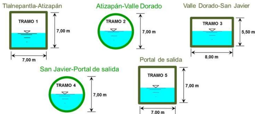
Fig. 98 Conagua. (2016). Secciones, Tramos principales de desagüe en la Zona de Valle Dorado. [Diagrama].
