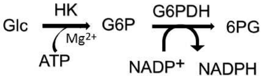
Figura 4.1. Sistema acoplante para determinar la concentración de glucosa (Glc) mediante la aparición de NADPH detectado a 340nm en una celda de reacción.
