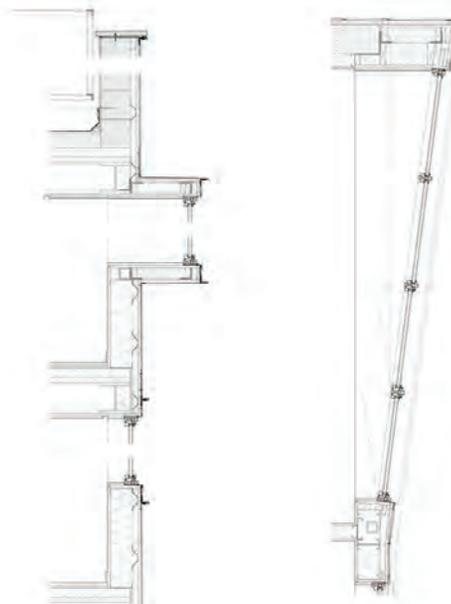
En cuanto a la envolvente nos permite tener un juego de vanos y macizos tanto en fachada como en cubierta, dicha envolvente se sostiene por medio de un sistema de instalación anclado a la losa y perfiles estructurales.
