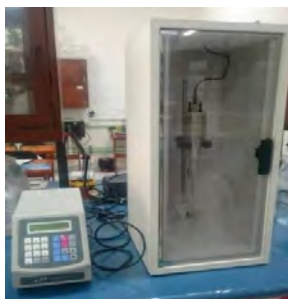
Figura 9. Procesador ultrasónico Cole Parmer CPX500.
