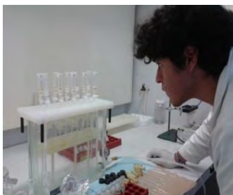
Figura 10. Sistema colector acoplado a una bomba de vacío con los cartuchos de Florisil montados.
