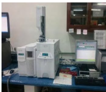
Figura 11. Cromatógrafo Agilent modelo 6850 acoplado a un detector de masas modelo 5975B
