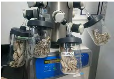
Figura 6. Liofilizadora (Labconco® modelo FreeZOne Plus 2.5)
