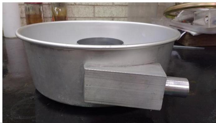
Figura 2.4.2.- Concentrador fabricado en el taller mecánico del Departamento de Ingeniería Metalúrgica, UNAM.
