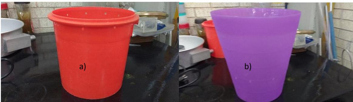
Figura 2.3.5.-Contenedores o trampas para retener medios a) cilíndrico y b) cónico (perforados por taladro).
