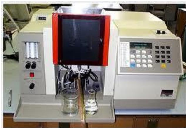
Figura 2.7 Espectrómetro de absorción atómica Perkin Elmer 3100
