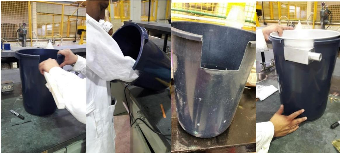
Figura 2.4.4.-Proceso de armado de la trampa principal (trampa para finos).
