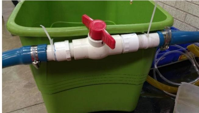
Figura 2.4.6.Union de llave, conector macho, coplee y manguera; con abrazaderas, cemento azul para pvc y cinchos de plástico.
