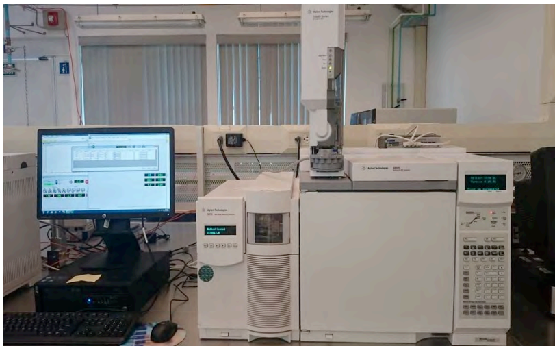
Figura 5.3 Cromatógrafo de gases acoplado a un detector de masas (GC-MS), empleado en este estudio.
