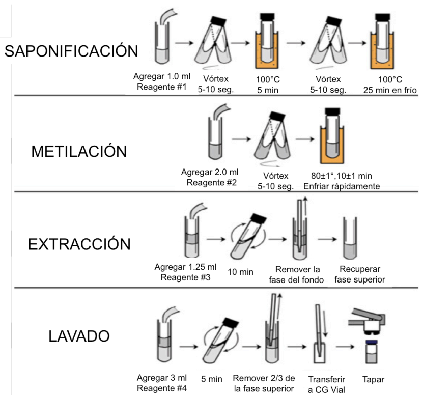
Fig. 6. Etapas del método de extracción de ácidos grasos, tomado de Wang y Jiang, 2016.
