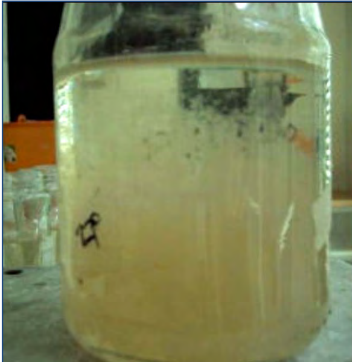
Figura No. 2. Prueba de jarras con adición de poliacrilamida. Fuente del autor.
