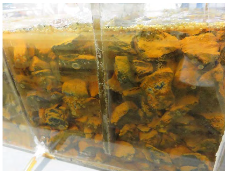
Figura 5.7 Recubrimiento de caliza con hidróxidos de Fe y Al
