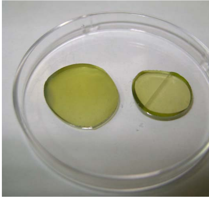
Figura 3.7: Aspecto de las muestras cristalinas después del corte y del proceso de pulido mediante las técnicas adecuadas.
