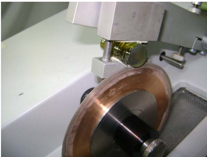
Figura 3.6: Aspecto del proceso de cortado de las muestras cristalinas, mediante una cortadora con disco de diamante.
