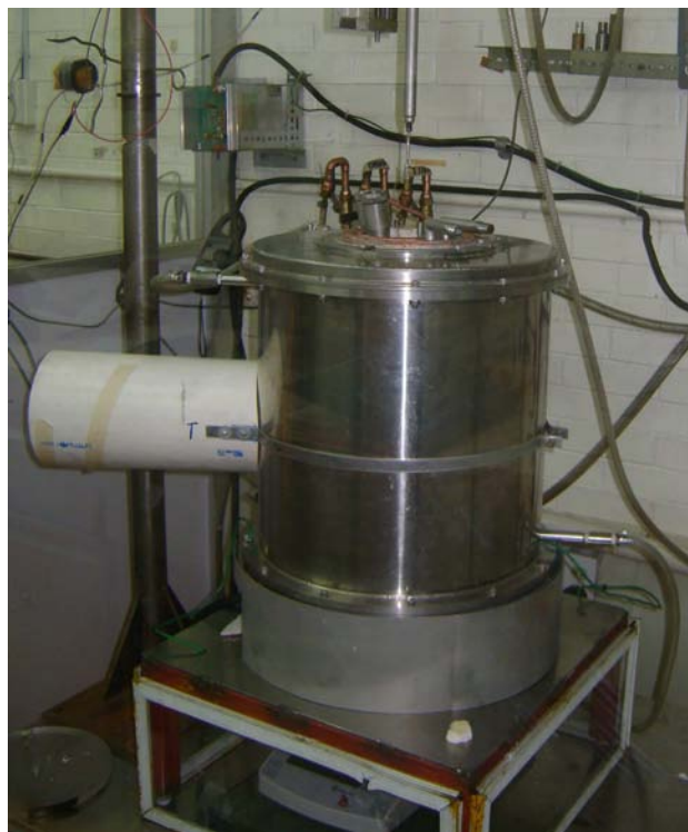
Figura 3.3: Imagen del horno de crecimiento del Laboratorio de Crecimiento de Cristales del Grupo de Propiedades Ópticas del IFUNAM.
