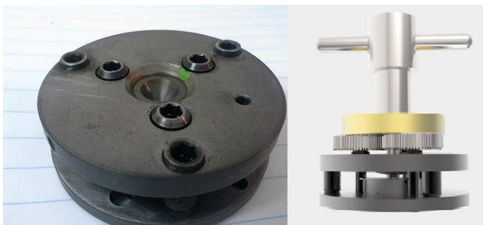
Figura 4.7: Aspecto de la celda DAC Boehler utilizada en los experimentos a alta presión.
