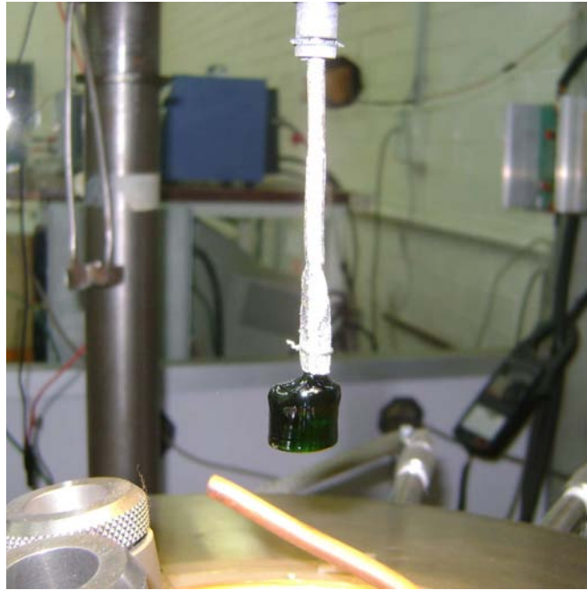
Figura 3.4: Aspecto de un cristal de LiNbO_3:Cr^{3+}; W^{4+} recién crecido en el Laboratorio.
