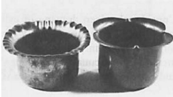
Figura 1.21. “Arrugas” formadas en la ceja de la lámina (en inglés, *wrinkling*) [50].
