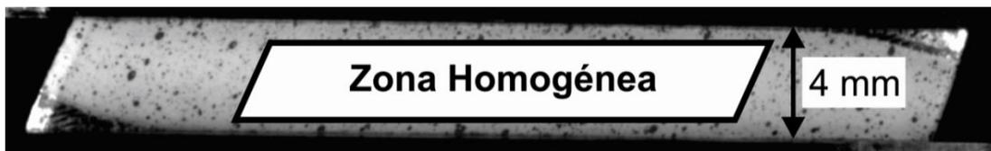
Figura 1.15. Región de estudio en una probeta para el ensayo de deformación cortante simple. Esta región se encuentra entre las mordazas que se observan en la Figura 1.13, donde además se señala la zona homogénea de la probeta que se encuentra sujeta principalmente a una deformación cortante simple. Se observa en las esquinas de esta región el deslizamiento ocasionado por la falta de control en la sujeción de las mordazas y la fricción involucrada.
