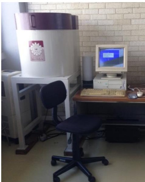
Ilustración 11 Detector de centelleo del Laboratorio 325, Edificio D de Facultad de Química, UNAM
