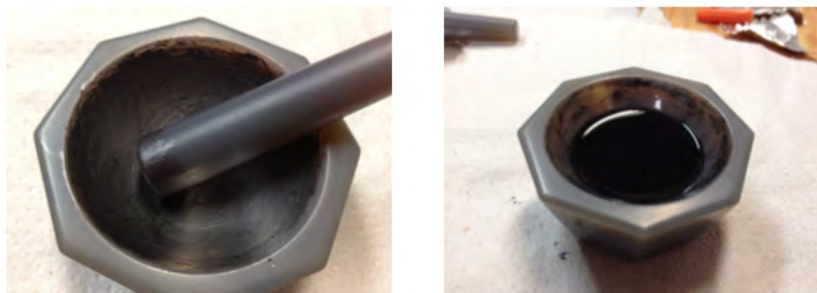
Figura 3.1: Proceso de molienda mecánica grafito + Triton X-100. Al incorporar el Triton X-100 en el grafito se obtiene una consistencia cremosa que después de diversas pruebas es un factor de tipo cualitativo que resulta ser importante para estimar si la molienda mecánica fue eficaz. Ya obtenida la crema de grafito se añade agua desionizada (de los 10 ml que serán empleados) para retirarla del mortero.
