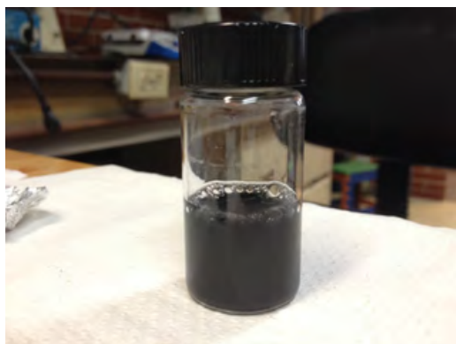
Figura 3.3: Suspensión de multicapas de grafeno en su segunda fase de síntesis. El proceso de sonicación permite una mejor dispersión de las plaquetas de grafeno después de ser exfoliadas mecánicamente.
