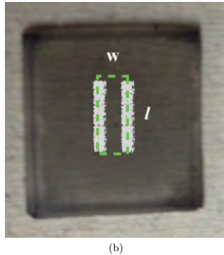
Figura 4.5: a) Imagen adaptada de [87] donde se muestra una representación de un resistor en película delgada. b) Contactos fabricados con pintura de plata sobre la PDMG considerando un área de 1 mm × 2 mm.
