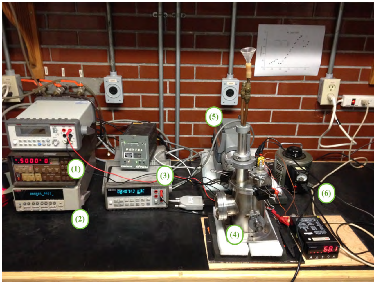
Figura 4.8: Sistema de medición de propiedades eléctricas en nuestro laboratorio. A la izquierda se tiene (1) un multímetro que suministra un voltaje fijo así como (2) un amperímetro que mide la corriente en intervalos de tiempo programados con Labview y, (3) un multímetro conectado a un termopar para medir la temperatura. En la parte central está (4) la cámara de vacío y detrás de ésta, se encuentra (5) la bomba turbomolecular de vacío que permite obtener una presión en la cámara alrededor de 10^{-4} Torr. En la derecha se tiene el sistema que controla la tasa de calentamiento con ayuda de (6) un Variivolt.
