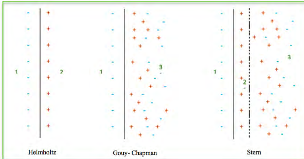
Figura 2.2: (1) Superficie del sólido, (2) Capa rígida, (3) Capa difusa. Izquierda: Modelo de capa rígida propuesto por Helmholtz en 1879. Centro: Modelo de capa difusa propuesto por Guy-Chapman en 1904. Derecha: Modelo de la doble capa propuesto por Stern en 1924.
