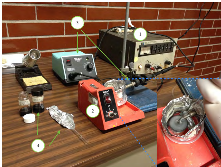
Figura 4.1: Montaje experimental para el diseño de películas delgadas. (1) Fuente de voltaje. (2) Motor eléctrico, 9.0 V. (3) Soporte y cautín. (4) SMG y pipeta. En la parte inferior derecha, se muestra una imagen ampliada del substrato de cuarzo montado sobre la superficie giratoria, la posición en la que se montó el cautín y cómo se depositaban las gotas de la SMG sobre éste. La distancia punta de cautín - substrato fue de \sim 1 cm.
