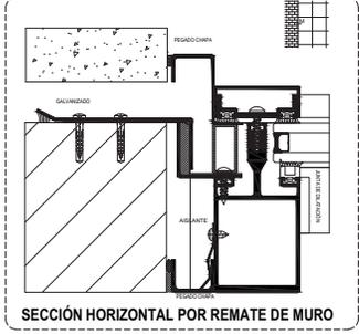
SECCIÓN HORIZONTAL POR REMATE DE MURO
