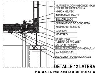
DETALLE 12 LATERAL DE BAJA DE AGUAS PLUVIALES
