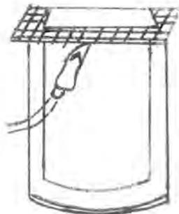
Una lata abierta y un pedazo de tela de alambre sirven como soporte para el esmalte en la quema con soplete.
