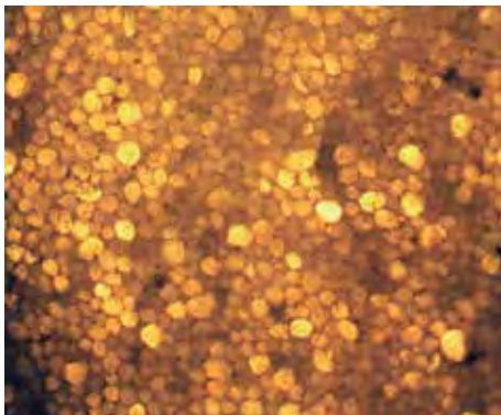
Figura 26. Fotomicrografía de fibras de lana fina. Corte transversal 100x Fuente: Laboratorio de ensayos a textiles, IPN. (2016).
