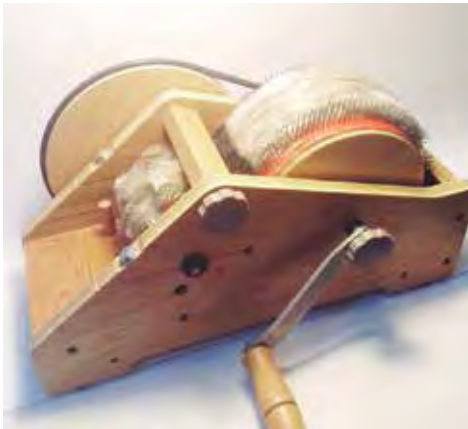
Figura 63. Cardadora Ashford de tambor Fuente: elaboración propia, 2016.
