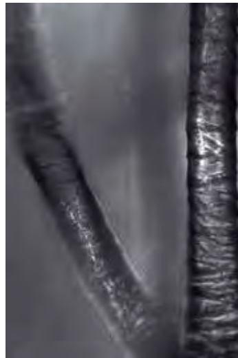
Figura 23. Fotomicrografía de fibras de lana. Vista longitudinal 400x Fuente: elaboración propia, 2015.
