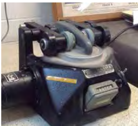
Figura 47. Abrasímetro Taber Fuente: elaboración propia, 2016.
