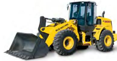
Pala mecánica. Máquina usada para excavar frontalmente todo tipo de material, excepto roca no triturada. Logra su mayor eficiencia en el caso de cavar desde el nivel del terreno en que está instalada hacia arriba, hasta la altura de su brazo, mientras que no funciona tan bien en el caso de cavar bajo su nivel de terreno.
