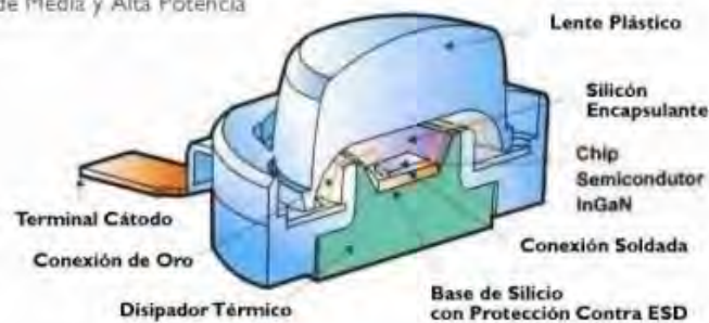
FIG 90: Led de baja y alta potencia.
