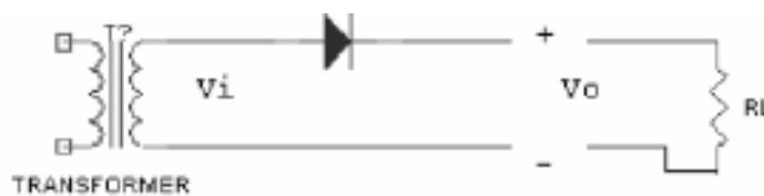
FIG 60: Transformador con un diodo
