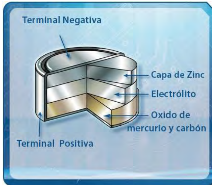
Fig. 43: Batería seca de mercurio
