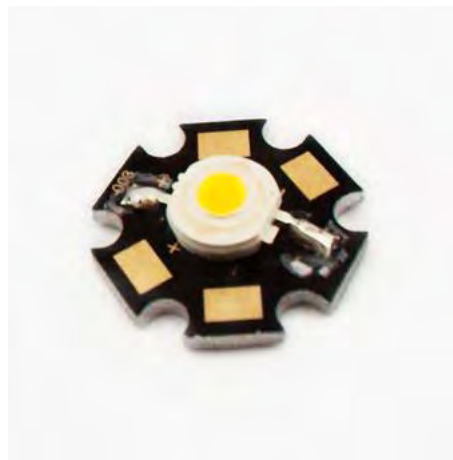
FIG 91: LED de alta potencia de 1w sin optica secundaria.
