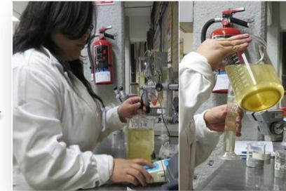
Se tomaron medidas iniciales de pH y CE del DAM a utilizar, así como el volumen necesario para tener una relación 1:1. Antes de colocar en reposo, se dio una agitación de 10 segundos con una varilla de cristal.
