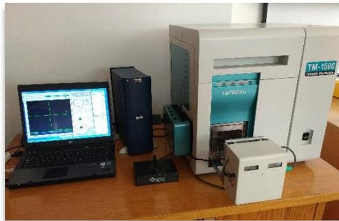
Figura 4.4. Microscopio Electrónico de Barrido-EDS.
