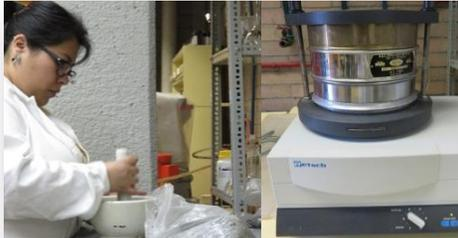
Se redujo el tamaño de la roca hasta -40+100# y se realizó el tamizado correspondiente.
