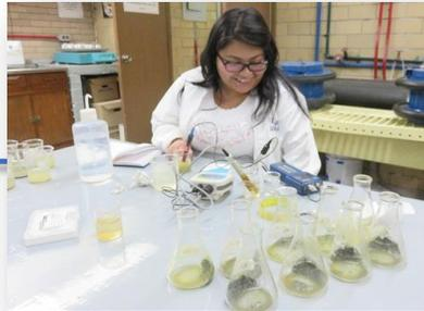
Posterior a la agitación, el contenido de cada matraz se vertió en un vaso de precipitado, para la medición de pH, CE y Eh.
