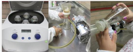
Finalmente las soluciones obtenidas fueron sometidas a centrifugado, filtrado y los sedimentos secados y pesados para realizar análisis.
