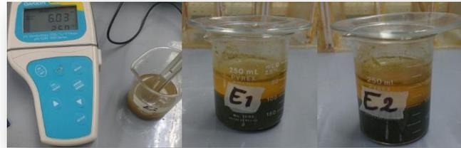
La medición de pH y CE se realizó de forma semanal, dando una agitación de 10 segundos antes y después de realizar la medición.
