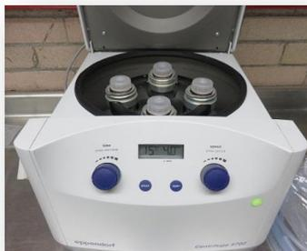
Para facilitar el filtrado de las soluciones fue necesario realizar el centrifugado de las mismas durante 15 minutos.
