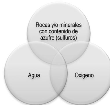
Figura 2.1. Elementos para la formación de DAM.
