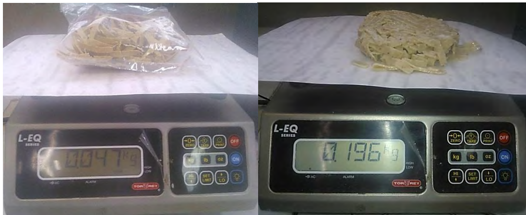
Figura 17. Grado de absorción de la formulación 50:40:10
