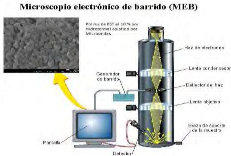
Figura 21.- Esquema del Microscopio Electrónico de Barrido
