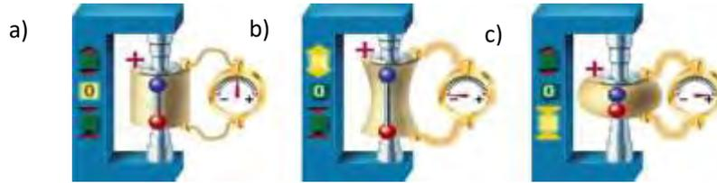
Figura 14.- Efecto directo de un piezoelectrico. Donde una perturbación mecánica en el material provoca una corriente eléctrica. En el inciso a) Se observa que el material se encuentra en reposo; b) Al material se le aplica un campo eléctrico negativo provocando una tensión; c) El material es perturbado con un campo eléctrico positivo y el material se comprime.
