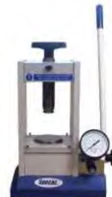
Figura 27. Prensa Specac, para la conformación de pastillas cerámicas
