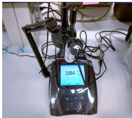
Fotografía 5. Medidor de temperatura, pH y conductividad modelo Orion™ modelo Versa Star™, usado en la experimentación
