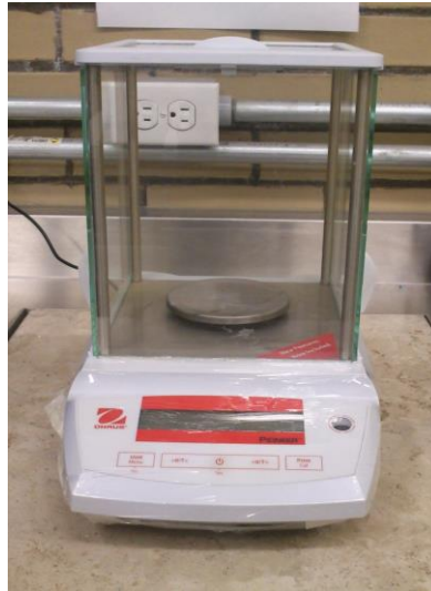
Fotografía 2. Balanza analítica marca Ohaus Pioneer PA224C, usada en la experimentación
