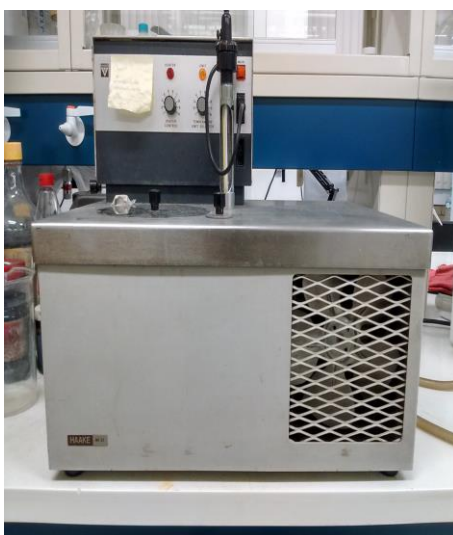
Fotografía 1. Recirculador de agua marca Haake, modelo NK22, usado en la experimentación.
