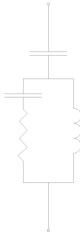
Fig.4.6 Conexión típica de un filtro amortiguado de tercer orden.
