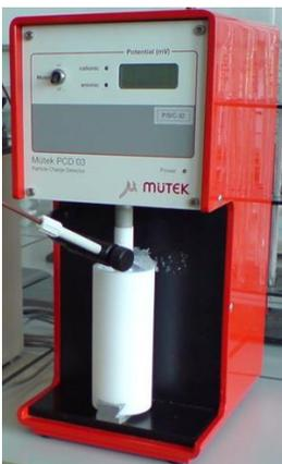
**Fig. 4.5 Equipo utilizado para la medición de la carga superficial de las nanopartículas.**
