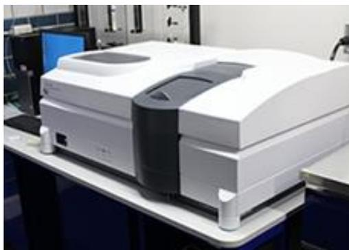
**Fig. 4.1 Espectrofotómetro UV- Visible- NIR (Cary 5000)**
