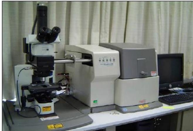
**Fig. 4.2 Espectrofotómetro Raman Dispersivo Nicolet Almega XR.**
