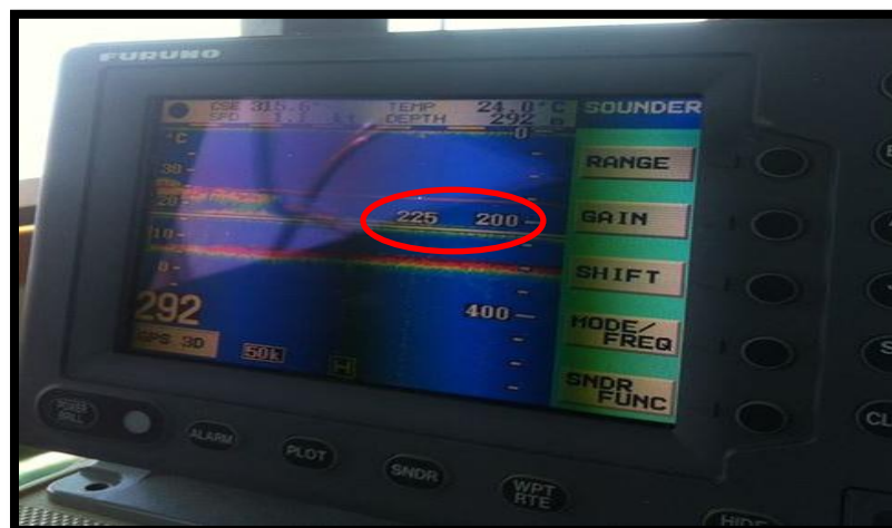
Figura 15. Pantalla de la ecosonda Furuno-GPS; a los 225 m se observa una capa de alimento (línea amarilla) siendo la profundidad total de 292 m. Zona cercana a la Isla San Pedro Nolasco.
